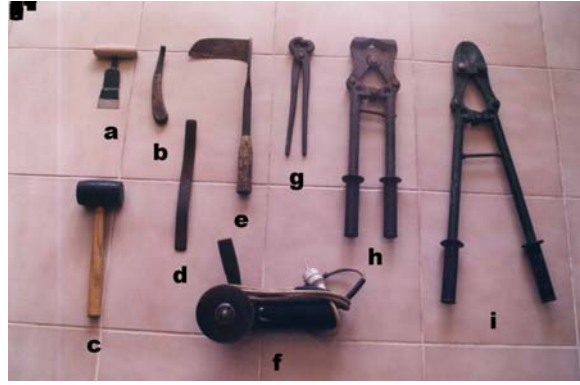
Resim 1. Tırnak kesiminde kullanılan bazı alet ve ekipmanlar a) Tırnak keski, b) Tırnak bıçağı-renet, c) Tokmak, d) Törpü e) Suntırıç, f) Avuç içi taşlama cihazı, g) Tırnak kerpeteni h ve i) Tırnak makası
