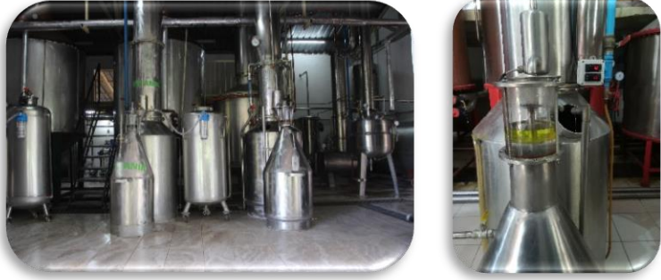
Şekil 23. Sanayi tipi gül distilasyon ünitesi
