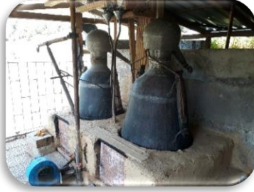
Şekil 22. Gül yağı eldesinde kullanılan bakır imbikler
