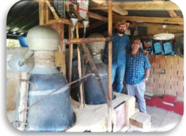
Şekil 22. Gül yağı eldesinde kullanılan bakır imbikler
