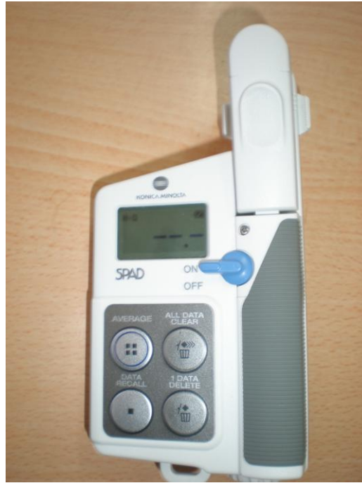
Şekil 4. Taşınabilir klorofil metre cihazı (Minolta SPAD-502, Osaka, Japan)
