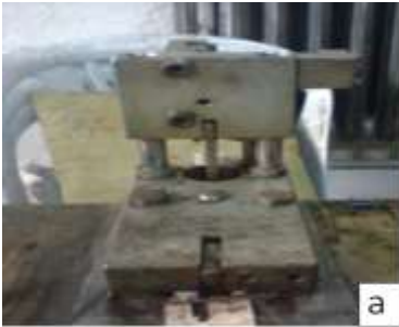
Şekil 2. Masa başı omega aşılama düzeneği (a) ve aşılama işlemi (b)
